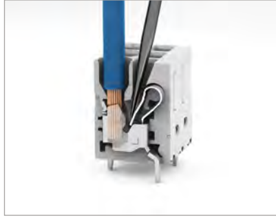
Çok damarlı iletkeni tornavida yardımı ile açın ve itin
