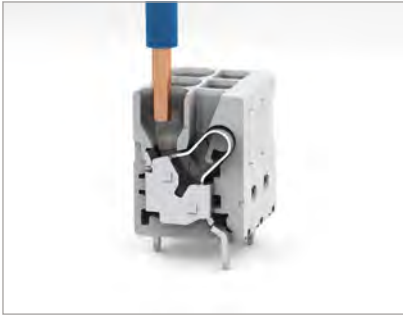
Tek damar iletkeni doğrudan el ile itin
